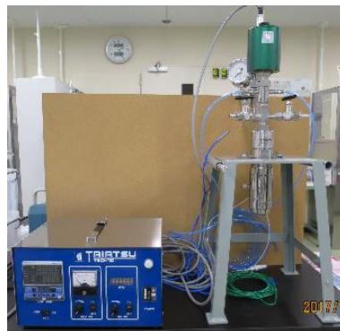
Fig.1 重水素化実験用の高温高压実験装置の写真。
