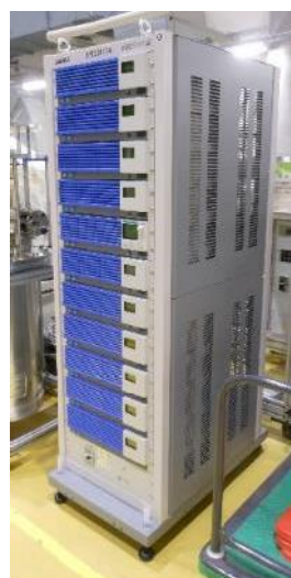
図 4. 導入したバイポーラ直流電源 (菊水電子工業製 PBZ40-110BP)
