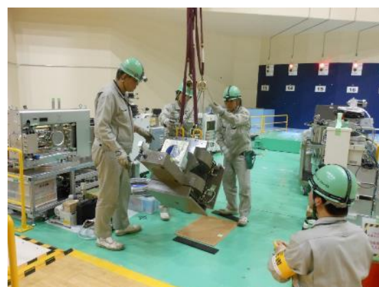
図 2. 1 T-Mag-BL17 をクレーンで立て起こしている様子。
